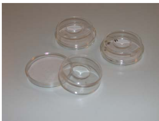
Figur 1. Filterpapir-test for resistens hos lus. Papir (d=3,5 cm) imprægneret med insektgift placeres i et låg fra en petriskål. Bunden, med et 1,5 cm hul, så der er fri luftudveksling, anvendes som låg. Der testes maksimum 10 lus pr. petriskål.
