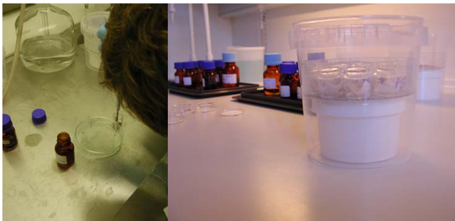
Figur 2. Dråbetest for resistens hos lus. En dråbe på 0,1 µl afsættes på en lus. Lusen overføres til et præparatglas med et lille stykke økologisk bomuldslerred. Glassene sættes på et trådnæt over en skål med mættet saltopløsning, som sikrer høj luftfugtighed. Der testes maksimum 10 lus pr. glas.
